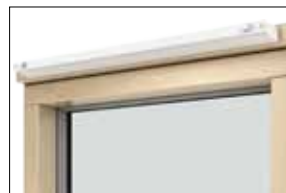
Lydventil. Er indbygget i en påføring, der monteres på vinduets overkarm. Udvendigt en alu-profil i samme farve som vinduet. Lydventilen har en støjdæmpende virkning på D_{n,e,w} 40 dB. Se faktaark om lydventilen på VELFAC.dk.
