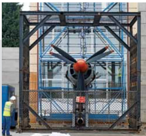
En 58m 2 stor vinduesfacade testes for vindlast. En del af testen omfatter, at en flymotor simulerer kraftige vindstød.
