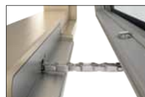
El-motor. Er indbygget i karmen og er derfor ikke synlig, når vinduet er lukket. Kan computerstyres og bruges i huse med naturlig ventilation. Fås i 3 forskellige kædelængder med en åbning på 60mm, 210mm eller 440mm. Se min/max. på VELFAC.dk
