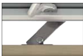
Åbningsbegrænser. Fås ikke til skydedøre. Fås også med ventilationsstillingslås til sidehængte, sidestyrede og topvendevinduer.
