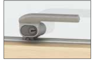
Termisk paskvilgreb til cylinderlås. Monteret med eller uden låsecylinder og nøgle. Kompositmateriale med metallisk vådlak.
