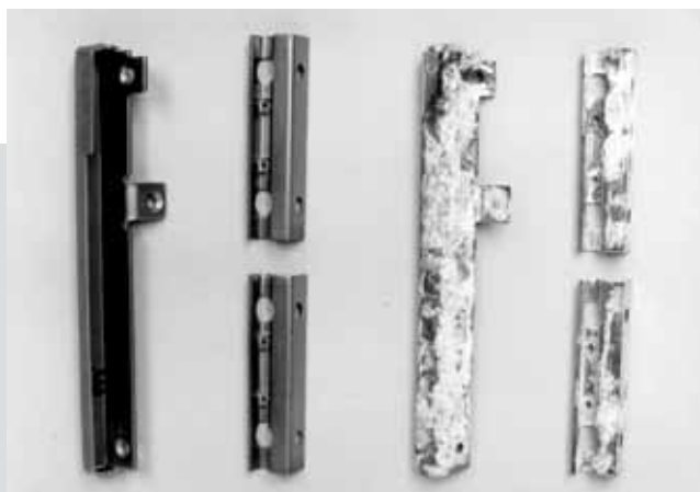
Efter CCT testen skal VELFAC beslagene stadig være uden spor af rust. Forskellen mellem en VELFAC korrosionsbeskyttelse (til venstre) og korrosionsbeskyttelse efter branchens traditionelle krav ses tydeligt.
