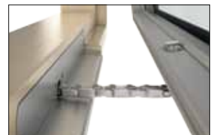
El-motor. Er indbygget i karmen og er derfor ikke synlig, når vinduet er lukket. Kan computerstyres og bruges i huse med naturlig ventilation. Fås i 3 forskellige kædelængder med en åbning på 60mm, 210mm eller 440mm. Se min/max. på VELFAC.dk
